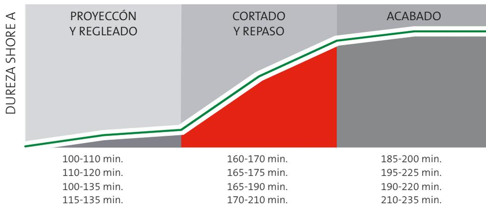
Nota: los tiempos de empleo pueden sufrir variaciones en función del tipo de soporte, temperatura ambiente y del soporte, relación A/Y empleada y Ph del agua empleada.
