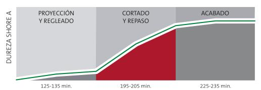
Nota: los tiempos de empleo pueden sufrir variaciones en función del tipo de soporte, temperatura ambiente y del soporte, relación A/Y empleada y Ph del agua empleada.
