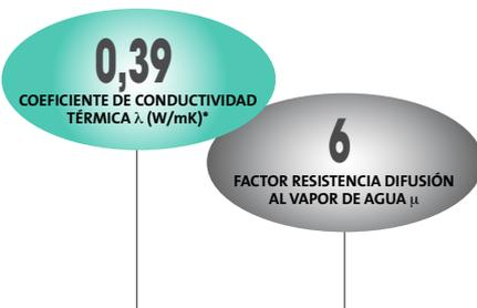
\*Determinación de la conductividad térmica según las pautas definidas en la EN-13.279-1. Los valores de referencia corresponden al material en seco utilizado en interiores (23°C y 50% de humedad relativa). Valor para el cálculo de parámetros característicos y particiones interiores según el CTE-DB HE-1.
