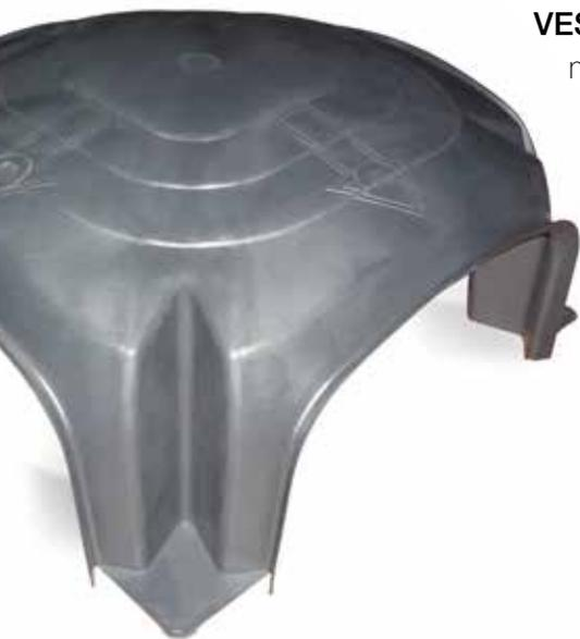
**VESPAIO SVELTO** se coloca generalmente sobre un fondo de hormigón magro de grosor variable según la aplicación. Tras la instalación de una rejilla electrosoldada adecuada, durante el proceso de hormigonado se forman pilares que, una vez madurado el hormigón, determinan la resistencia efectiva del pavimento, con la distribución de las cargas de forma homogénea sobre toda la superficie.
